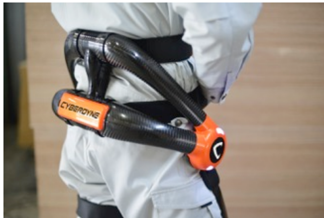
安全祈願祭で装着した HAL®作業支援用（腰タイプ）
