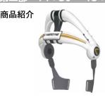
HAL® 腰タイプ自立支援用は、足腰の弱った方などの体幹・下肢のトレーニングを補助する装着型ロボットです。
